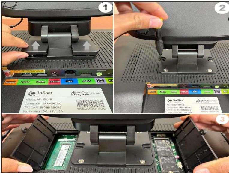
**Acceso rápido, sin tiempo de inactividad:** acceso rápido a su RAM y SSD en un simple paso de 1-2-3. El P4 está diseñado pensando en su negocio, ofreciendo un fácil acceso para actualizar RAM y SSD en solo tres sencillos pasos: minimizar el tiempo de inactividad y maximizar la eficiencia.
